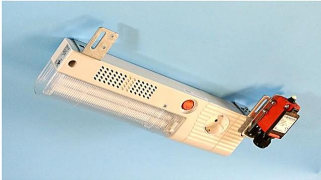
Serie di dispositivi per l'illuminazione interna degli armadi elettrici con lampada fluorescente ad accensione elettronica a basso consumo protetta da schermo. Corpo in materiale plastico di colore grigio, equipaggiato di presa di servizio 16A e di interruttore manuale di accensione. Il dispositivo può essere impiegato nella quasi totalità degli armadi con cornici preforate a passo 25mm presenti sul mercato; è adatto ad essere montato anche in posizione verticale sul montante.
